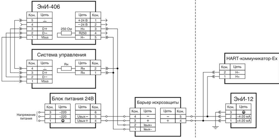
**Рисунок В.5** — Вариант включения датчика с барьером искрозащиты с гальванической развязкой сигнальных цепей и цепей питания
