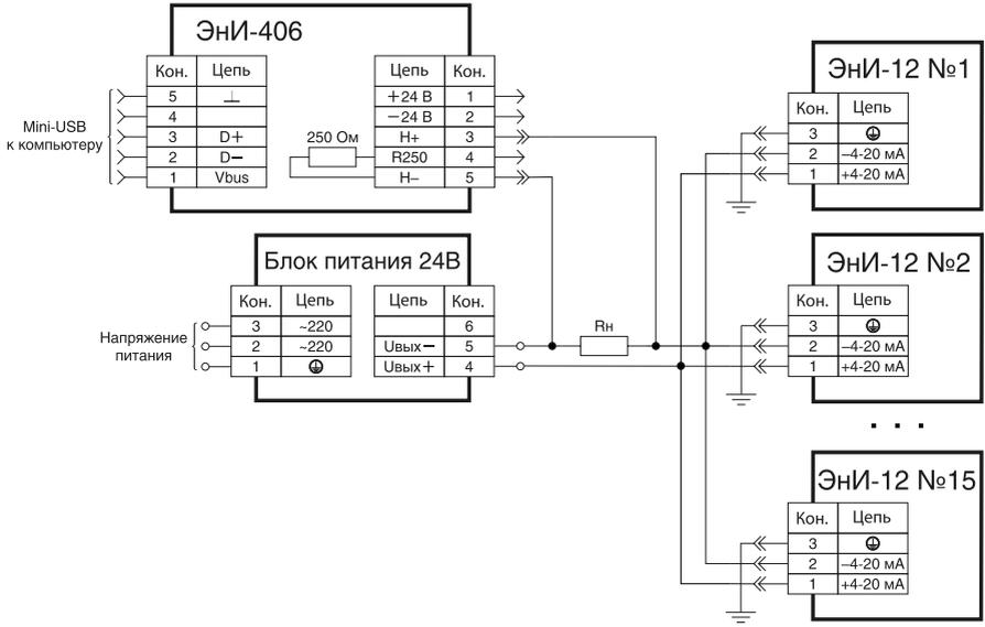
**Рисунок В.6** — Схема подключений нескольких датчиков при работе по HART-протоколу
