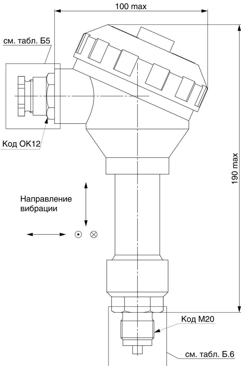
Рисунок Д.4 — Габаритные и присоединительные размеры датчика ЭНИ-12Н моделей ДИ, ДА, ДИВ, ДВ, только для моделей с индексом «м»
