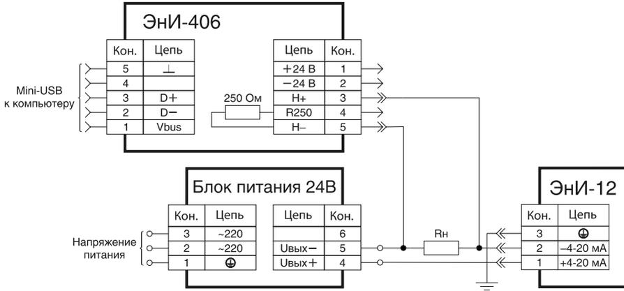
Рисунок В.1 — Подключение датчика ЭНИ-12
