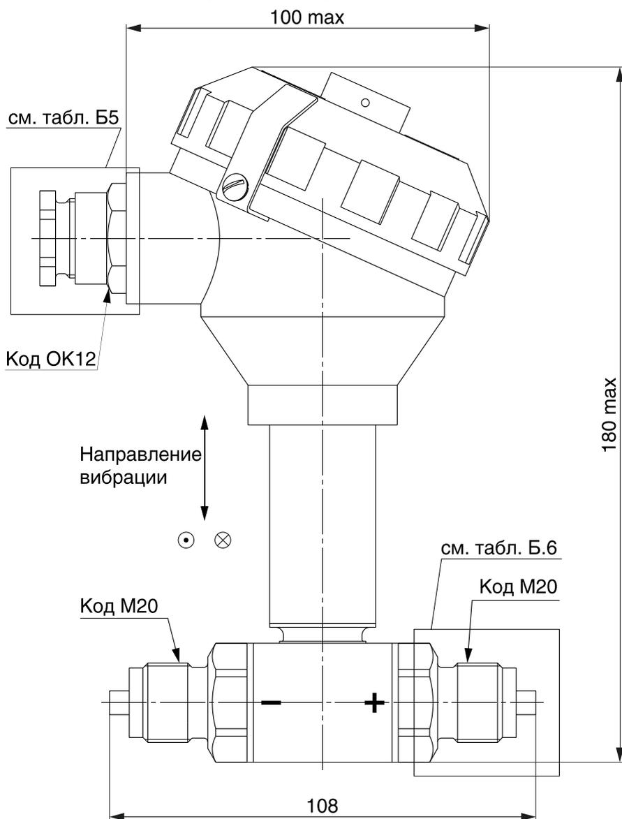
Рисунок Д.6 — Габаритные и присоединительные размеры датчика ЭНИ-12HS моделей ДД
