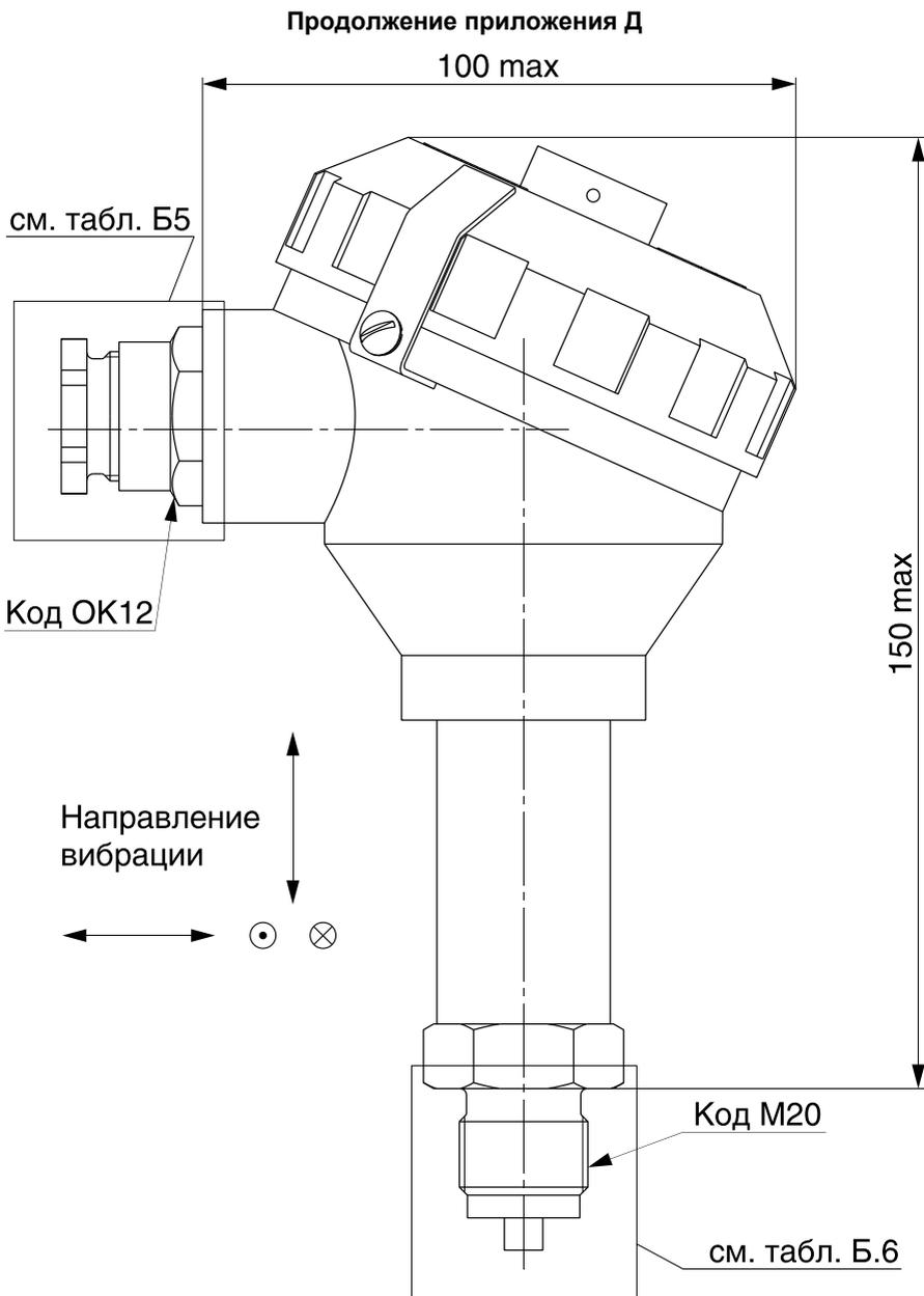
Рисунок Д.3 — Габаритные и присоединительные размеры датчика ЭНИ-12HS моделей ДИ, ДА, ДИВ, ДВ, кроме моделей с индексом «м»
