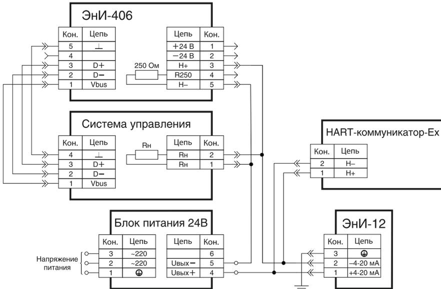
Рисунок В.2 — Вариант включения датчика с HART-модемом
