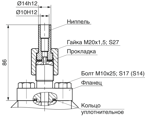
Рисунок Д.3 — Датчик с установленным ниппелем под накидную гайку M20x1,5 (в количестве 1 или 2 в зависимости от модели). Остальное см. рисунок Д.1. Применяемость в соответствии с кодом присоединения к процессу
